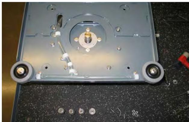
**INSTALLING LOWER ORBITAL HEAD ISOLATOR**
